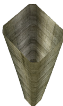
Modèle 3D texturé d'une pile de pont (interne) Section carrée de 4m x 4m / 50m de profondeur
