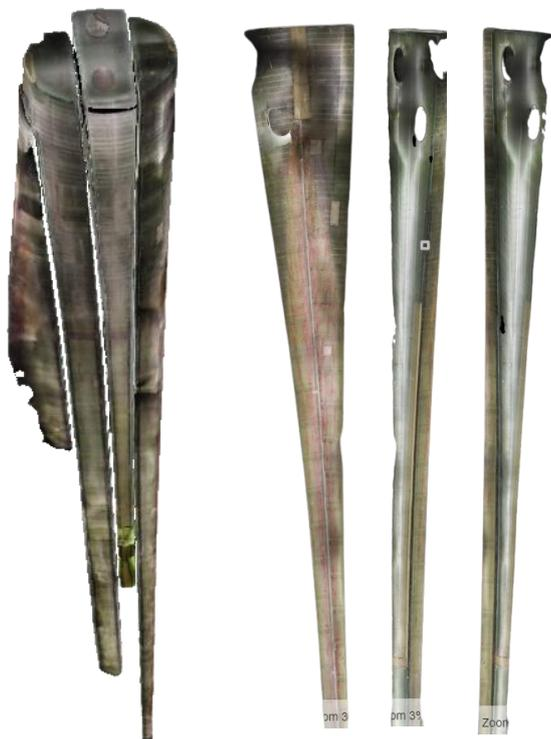
Modèle 3D d'un intérieur de pale
