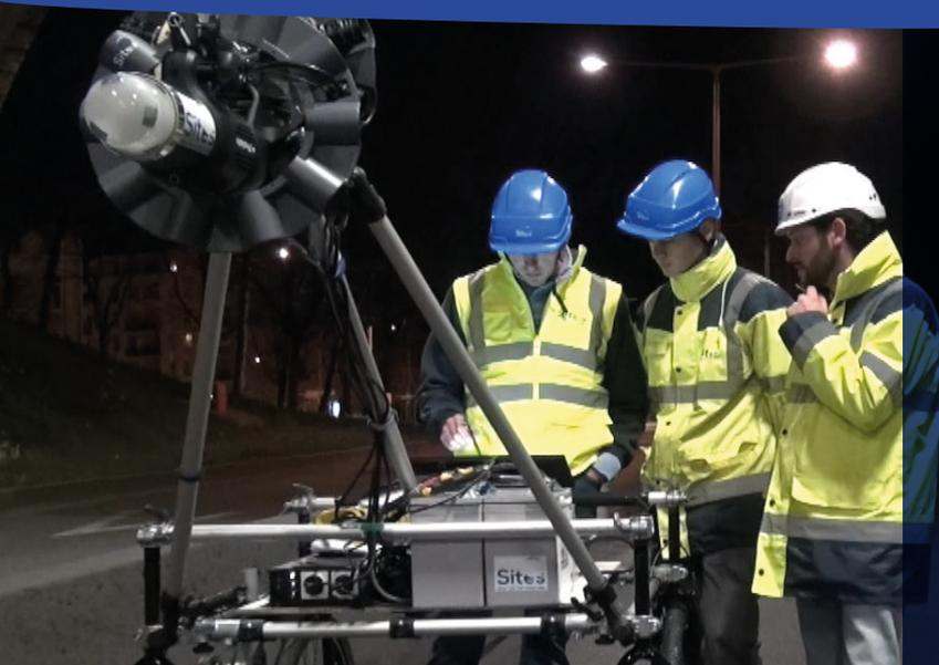
L'outil ScanTubes® permet de parcourir horizontalement ou verticalement des tubes pour réaliser automatiquement des photos haute résolution à 360° et saisir la géométrie 3D de la structure via traitement photogrammétrique.
