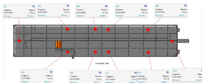
Simon-e® - Positionnement et valeurs des capteurs d'un ouvrage instrumenté
